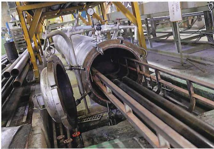
加硫缶に入れ、150度の蒸気により60分間加熱する。この「加硫」という工程によりばらばらだった分子がつながり、伸びても元に戻るゴムの特性が生まれる。また、圧力をかけながら熱することで各層が一体化し、透明セロファンが溶けて表面を覆うことで艶やかな光沢が得られる。
