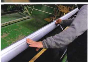
さらに、外面ゴムの重なり部分を隠すように白い板ゴム、それに沿って反射テープを貼る。白色や黄色の太い線には細いゴム板を使用し、反射ラインには反射テープを使用している。さらに透明セロファンを最外面に巻きつける。
