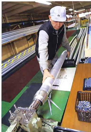
日本消防協会協会による受託個別試験の後、仕上げ作業として吸管の両端に金具を取り付ける。
