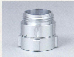
吸口スィベル媒介 吸管のキンク防止に既存の 吸口エルボに取付けて使用
